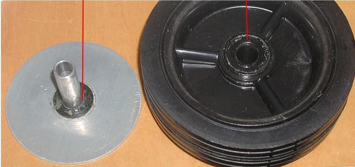
**CORROSION LOCKED ITEMS TOGETHER.**
